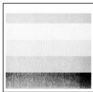
左侧是第一个范例，其显示的是设定不正确“纸厚度调节”。对于标准的标签纸，纸厚度调节指示器应设于窗口的中间刻度。
