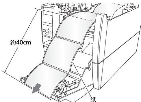
4. 在纸尖端位置，从底纸上剥除一定数量的标签，这样，在关闭回卷器盖时，底纸单元便可接触剥离辊。
