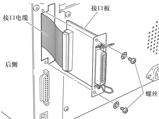
2. 将连接电缆从接口板上拆下，然后将电缆重新连接至用于更换的接口板的连接器。
