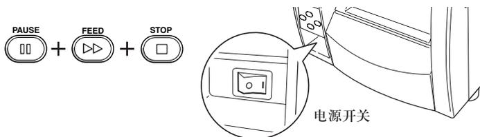
2. 在 Sensor Cal Mode（传感器校准模式）指示灯亮起之后，松开各键将打印机模式改为传感器调节设定模式。
