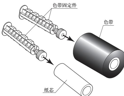
2. 将新的色带以及固定件装进后色带驱动单元。使色带驱动齿轮机械上的花键与色带固定件的尾端吻合。
