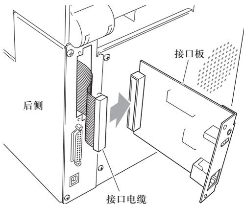
3. 将接口板插入打印机，使连接电缆不会阻碍打印机，然后用之前拆下的螺丝（2）固定支架。
