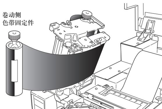
5. 将已安装好纸芯的色带固定件安装进色带驱动单元，然后按箭头所示方向转动色带固定件以张紧色带及消除褶皱。
