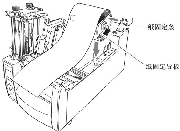
4. 如上图所示，将纸卷和纸固定件装入打印机中。建议您向前拉出一段并穿过机械装置，以备以后进行定位。
