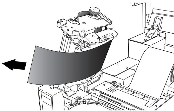
4. 使用胶带将拉出的色带粘于已装有纸芯的色带固定件上，然后将色带缠绕在色带固定件上。
