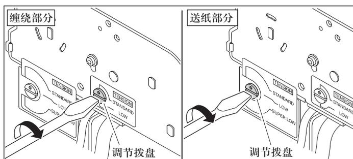
当旋转缠绕部分的调节拨盘时, 请使用平头螺丝刀。
