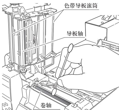
如果标签纸的胶粘附到辊上，底纸将会粘在上面并引发阻塞。请使用蘸有酒精的软布或其他类似物擦拭粘附在辊上的胶。
