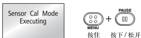
4. 如果自动调节正常停止, 液晶屏上会显示 **Succeeded** (成功)。如果其异常停止 (无法进行调节), 故障指示灯闪烁, 并且液晶屏上显示 **Failed** (失败)。
