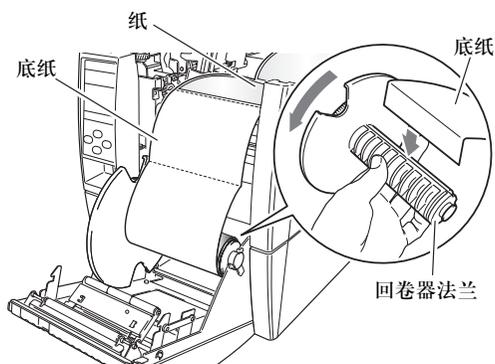
6. 检查并确保底纸单元正确地设置在剥离辊中，然后关闭回卷器盖。
