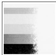
左侧是第二个范例。其显示的是设定不正确的“纸宽度调节”。对于 4 英寸或 100 mm 宽的纸，调节器应设于窗口中的 100 mm 刻度。
