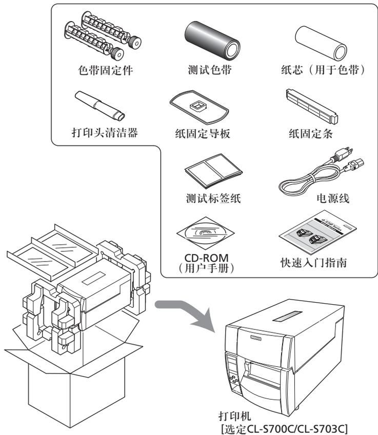
说明：空箱子和包装材料应存放起来以备将来装运打印机之用。从包装箱中取出 CL-S700RC 时，里面另设有一纸箱“吊绳”，能够进一步简化上提。
